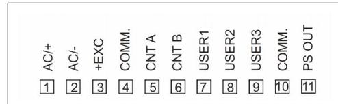
Die Masseanschlüsse der Signaleingänge und der Benutzereingänge sind nicht galvanisch getrennt.
