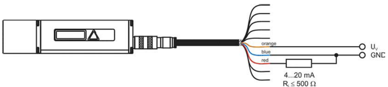
Abbildung 19: Beschaltung Analogausgang
